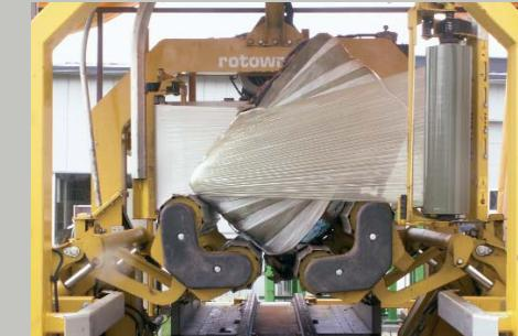
Ballen. Das Transportsystem befördert den Ballen zwischen die oszillierenden Walzen. Diese heben ihn in die Wickelposition. Der Wickelprozess beginnt.
