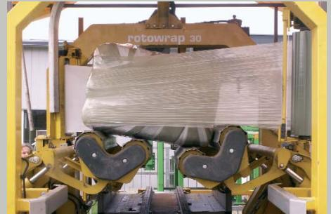
El sensor de entrada detecta la bala y el sistema de transporte la conduce hasta los rodillos oscilantes.
