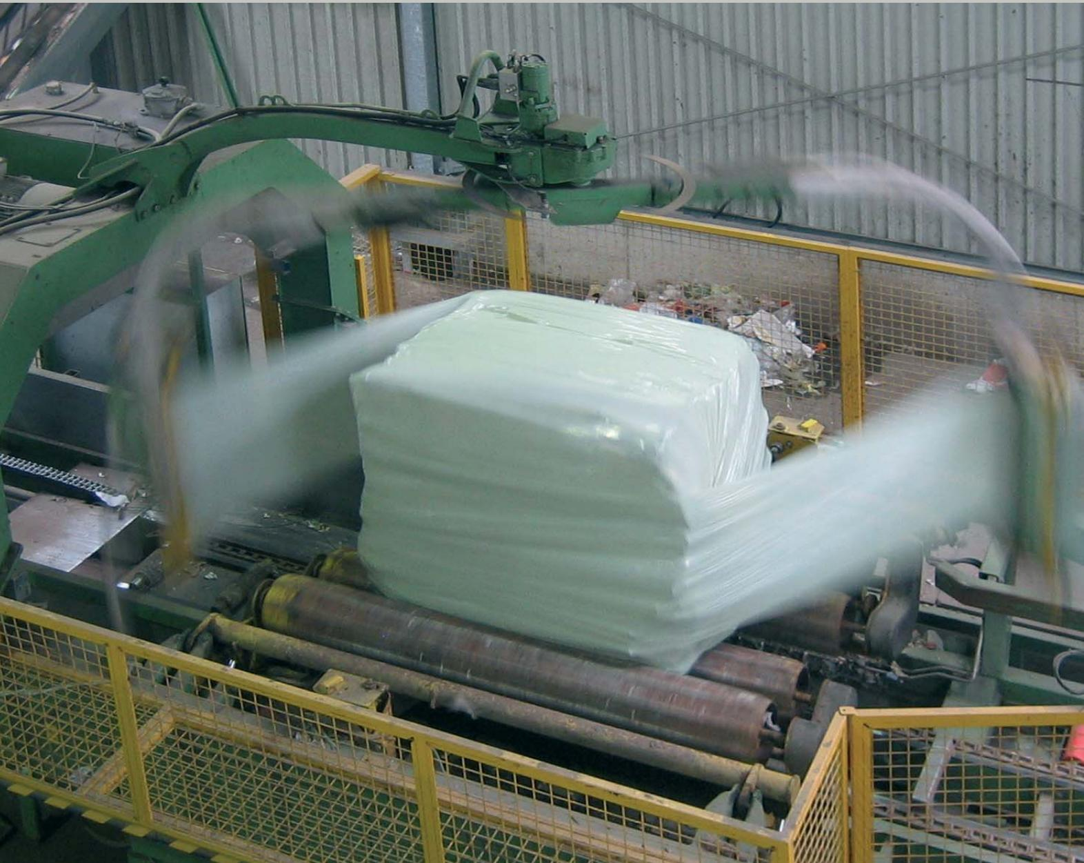
Bei der Ballenwickelmaschine ROTOWRAP werden im Gegensatz zu anderen Systemen beide für das vollständige Einwickeln eines Ballen bzw. Quaders notwendigen Drehungen gleichzeitig durchgeführt.
